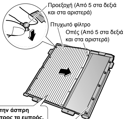
Μονάδα καταλύτη αποσμητικού
